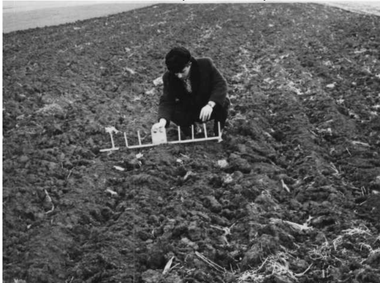
Визначення гребенистості оранки
